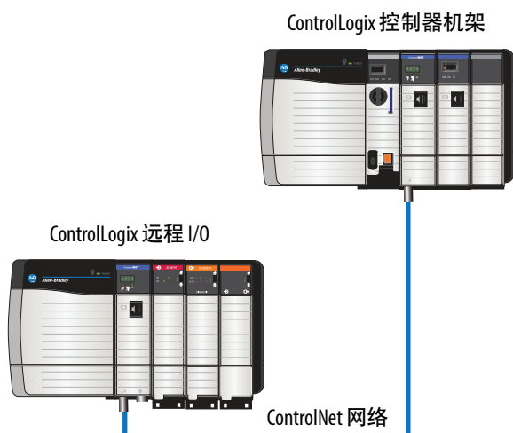
图 22 - ControlLogix 控制器和远程 I/O 示例
